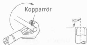
Korrekt flärning av rör
